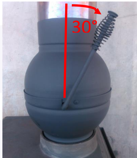
Figura 1. Posición abierta del catalizador, la cual permite la limpieza de los caños y el encendido de la estufa.
